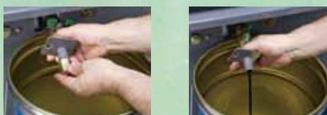
ボルトを外す事により手前に引き出せる新構造を採用しました。オイル交換時に便利です。
