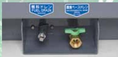
1インチの大口径ドレーンバルブを採用。環境保護ベース内に溜まった雨水等も簡単に排水処理が可能です。
