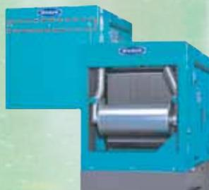
ボルト3本を外す事によりフロントカバーを簡単に外せます。ラジエータの清掃時に便利です。
