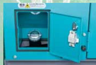
給油時に油をこぼしても、外部に漏れない構造です。また鍵付なので燃料の盗難を防止できます。
